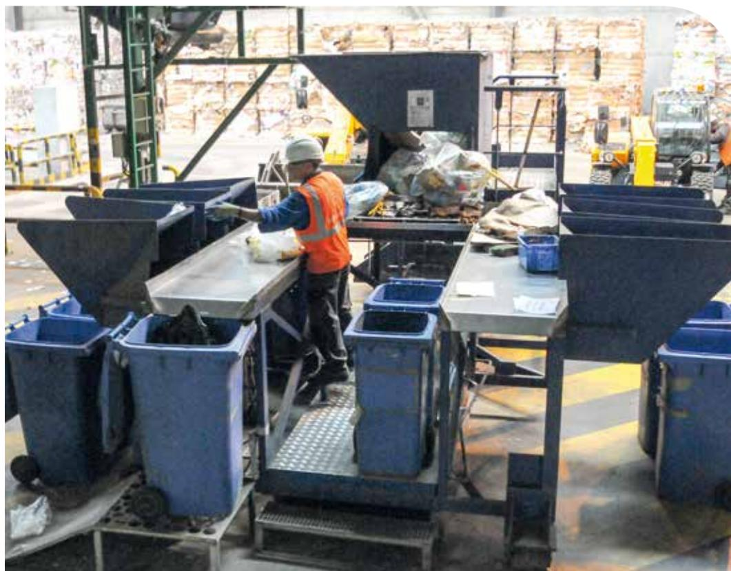
← Installée au cœur de l'UTM, une table de caractérisation permet de définir la proportion de matériaux dans un échantillon de collecte sélective. Plusieurs caractérisations sont réalisées pour chaque collectivité cliente.
