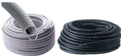
Gaine ICTA 3422 de couleur gris ou noir équipé d'un tire-fil – existe en couronne de longueur de 50 et 100 mètres.
