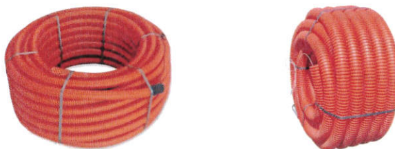
Gaine TPC avec et sans manchon, cintrable de couleur rouge équipé d'un tire-fil (résistance de 40 à 60 daN) – existe en longueur de 25 ou 50 mètres.
