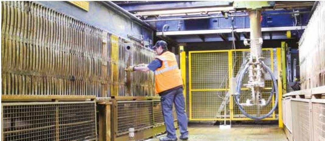
*Pour être transportées plus facilement, les boues sont déshydratées par filtres-presses (photo), par filtres-bandes, par centrifugeuse ou par séchage.*
