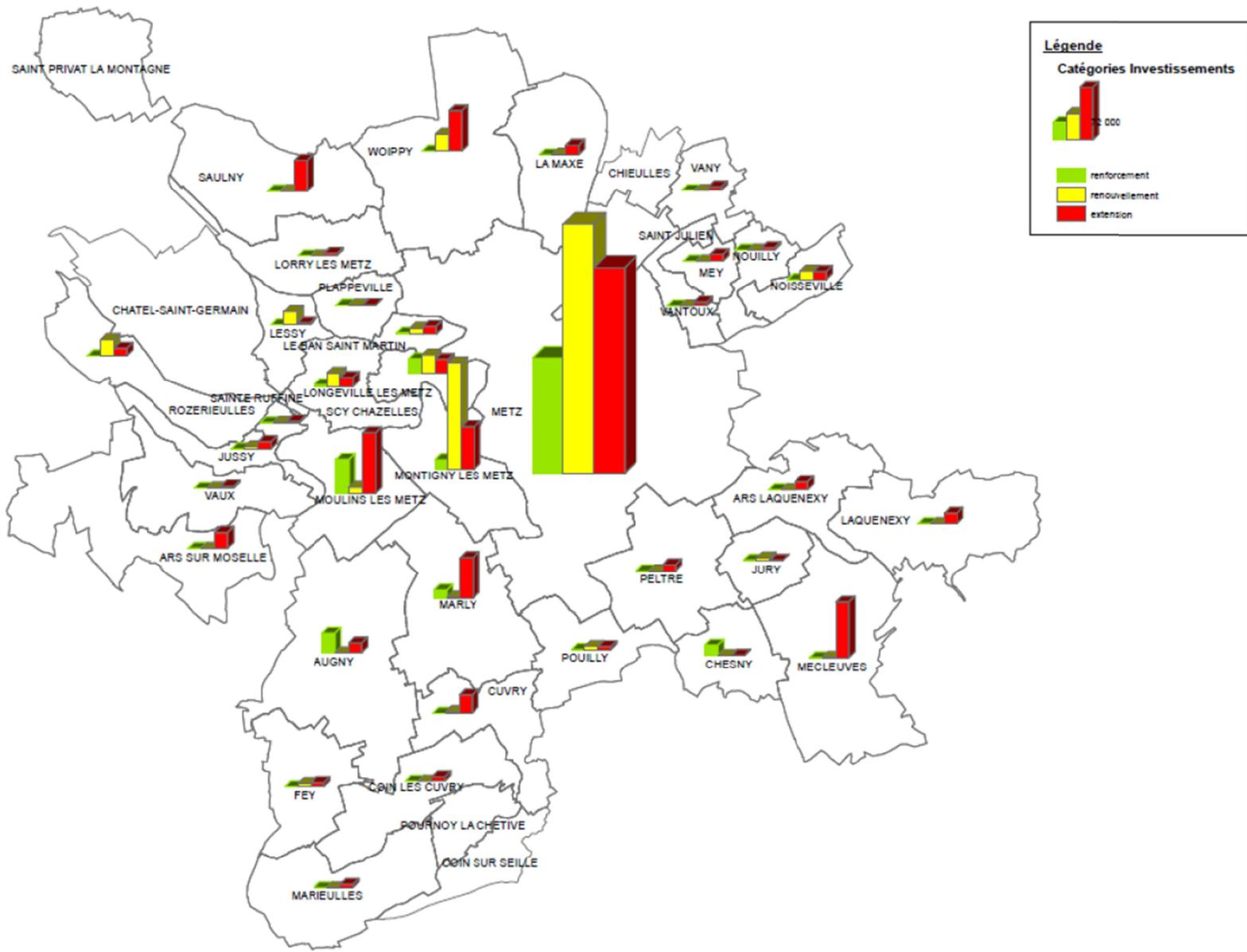
Figure 5 : cartographie des investissements URM par commune en fonction de la nature des travaux (renforcement, renouvellement ou extension)
