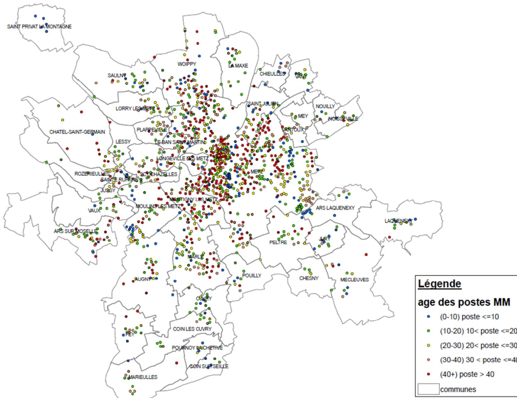
Figure 8 : Répartition des 1301 postes de transformation HTA/BT de Metz Métropole par âge.
