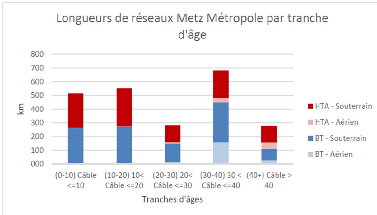
Figure 7 : répartition des kilométrages des réseaux en fonction de leur âge (en km), réseau BT non exhaustif
