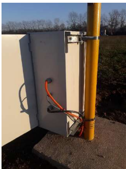
Piézomètre implanté et premières remontées de mesure de conductivité
