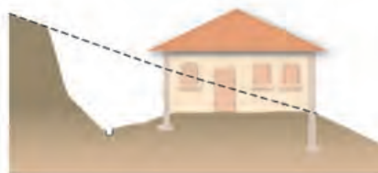
Plate-forme en déblais
