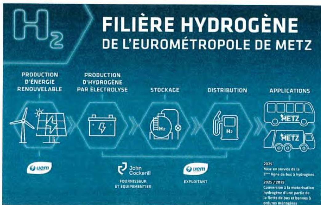
Le projet vise à implanter en 2025 une station de production et de distribution d'hydrogène par électrolyse de l'eau qui serait située a priori au nord de Metz. L'électrolyseur sera alimenté par de l'électricité renouvelable via des contrats longue durée et des certificats de garantie d'origine qui devrait provenir d'une installation photovoltaïque située à Metz et d'un parc éolien en Moselle.
