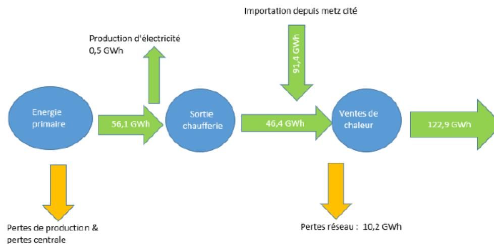
Figure 13 : Représentation du fonctionnement de la centrale de Metz Est
