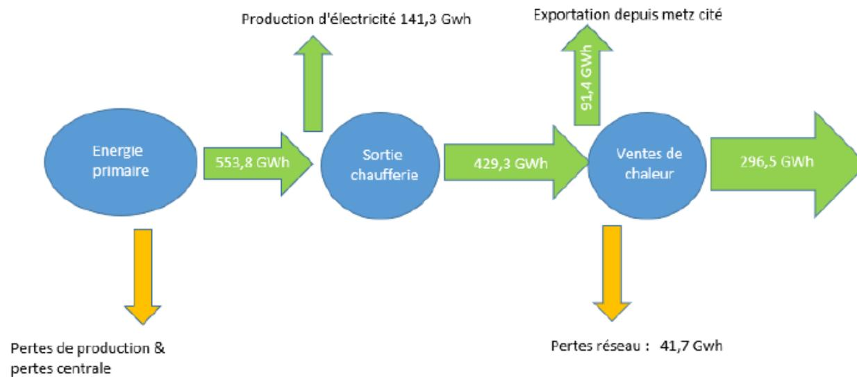
Figure 7 : Représentation du fonctionnement de la centrale de Chambière
