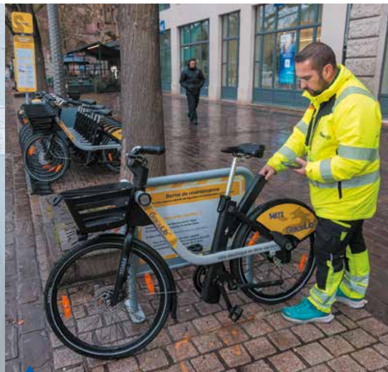
Yannick remplace la batterie d'un vélo placé par un usager sur la borne de dépannage en station.
