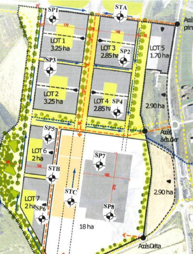
Localisation des sondages – Source : Géotec
