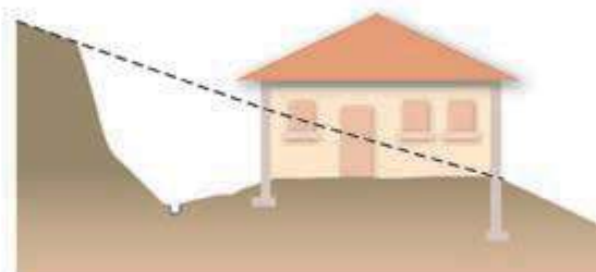
Plate-forme en déblais
