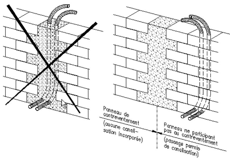
Percements et saignées : interdits dans les murs de contreventement
