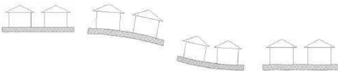
En fin d'affaissement, le bâti se trouve sur l'une de ces quatre configurations.
